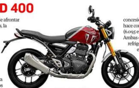
concesionarios españoles de la marca. Y lo hace con dos opciones, la Scrambler 400 X (6.095 euros) y esta Speed 400 (5.395 euros). Ambas con un monocilíndrico de refrigeración líquida de 398 cc que entrega 40 CV a 8.000 vueltas y par motor máximo de 37 Nm en las 6.500, con cambio de seis relaciones. Tienen subchasis trasero atomillado de tubo de acero y estructura híbrida de doble viga/perimetral, el
